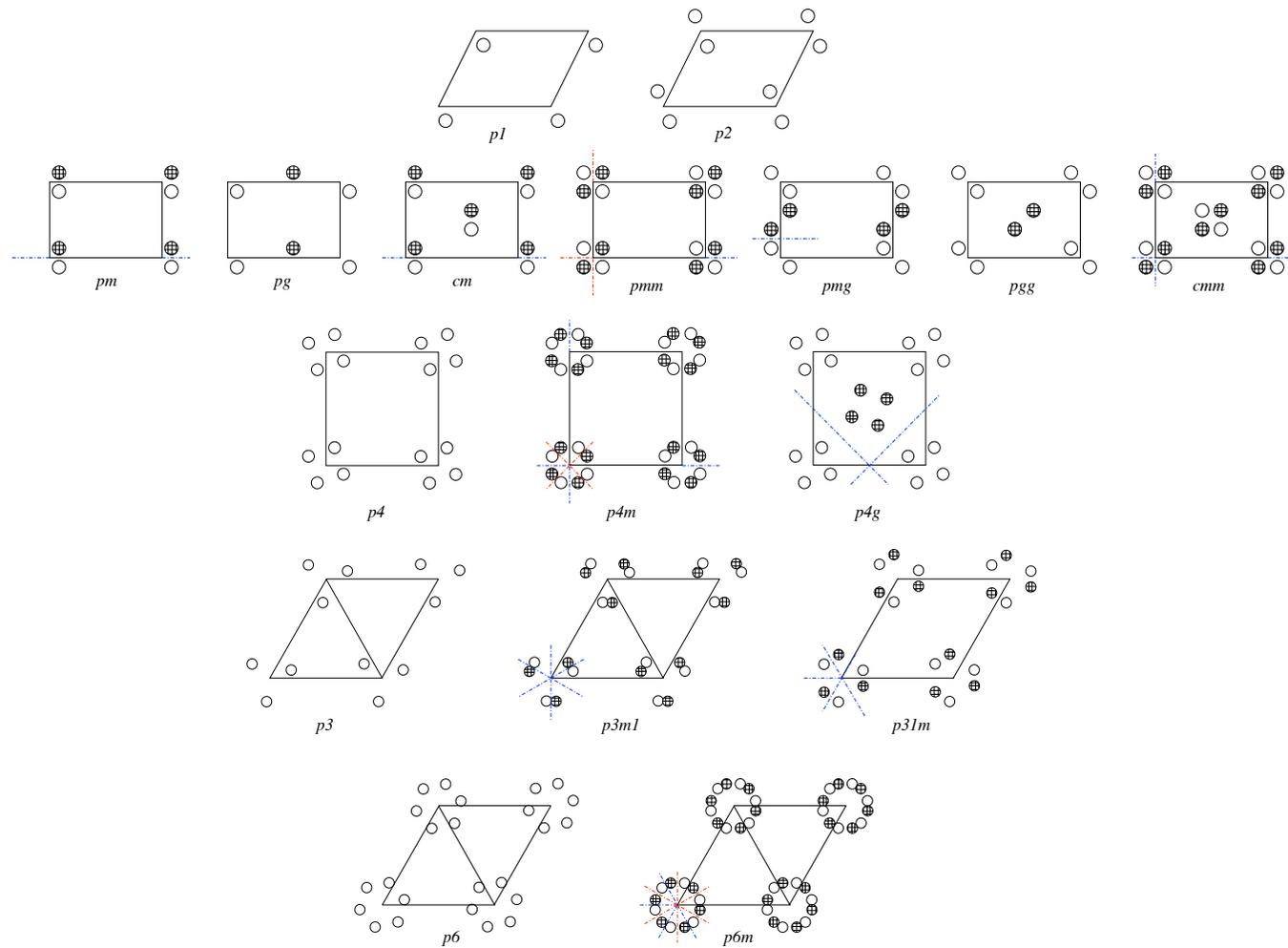
FIGURE 17 – Les 17 types de réseaux cristallins à  $d = 2$  dimensions.
