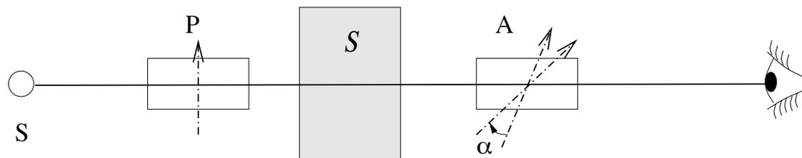
FIGURE 10 – Pouvoir rotatoire d'une substance : un faisceau polarisé linéairement par un polariseur P traverse ensuite une substance "optiquement active"  $\mathcal{S}$  : on constate que l'analyseur A doit être tourné d'un angle  $\alpha$  pour retrouver l'extinction du rayon lumineux.
