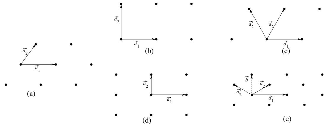
FIGURE 16 – Les 5 classes de réseaux de Bravais à 2 dimensions. Successivement, (a) réseau *monoclinique*; (b) réseau carré (ou *tétragonal*); (c) réseau hexagonal; (d) réseau *orthorhombique* (ou rectangulaire); (e) réseau rectangulaire centré.
