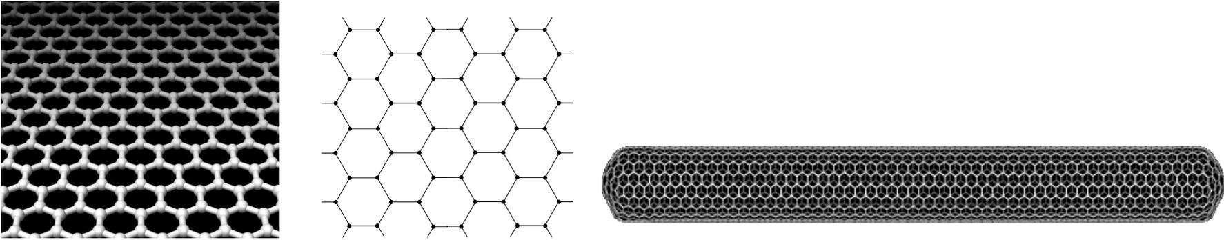
FIGURE 4 – Graphène. Nanotube de carbone
