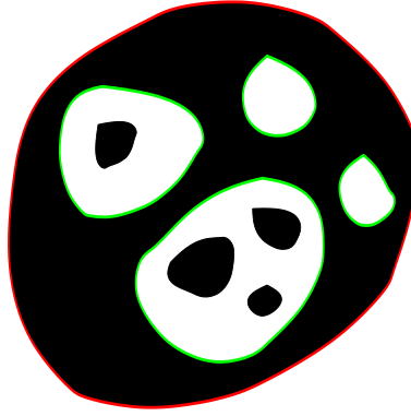
FIG. 4.13 – Le grand domaine up (représenté en noir) contient plusieurs domaines down (en blanc). En un temps \Delta t , son périmètre extérieur (en rouge) contribue à une diminution de sa surface de \lambda\Delta t . Son périmètre intérieur (en vert) contribue à une augmentation de sa surface de 4\lambda\Delta t . Au final, l'aire totale du domaine augmente.
